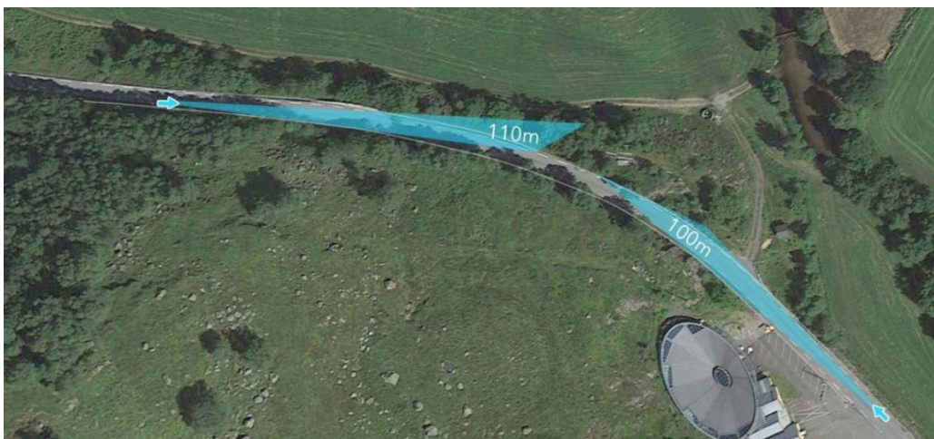
Figur 7: Viser vegstrekingens sving som forårsaker dårlig sikt.
