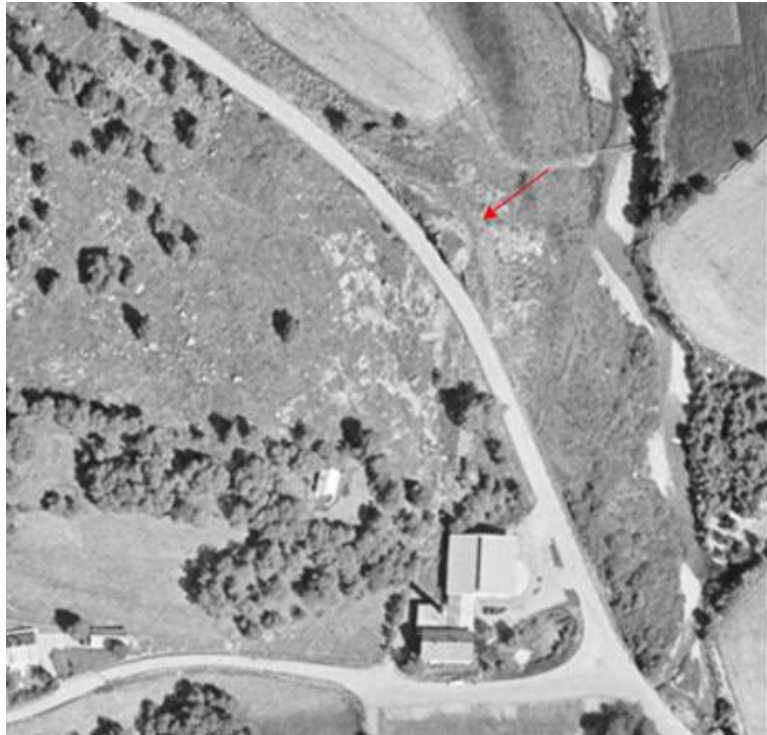
Figur 20: Flyfoto 1974. Eldre veg (ca 1881) på utsiden av dagens fv450 i planområdet (rød pil) viser at slyngen rundt berget ut på 1900-tallet er rettet ut med omlegging gjennom fjellskjæring.
