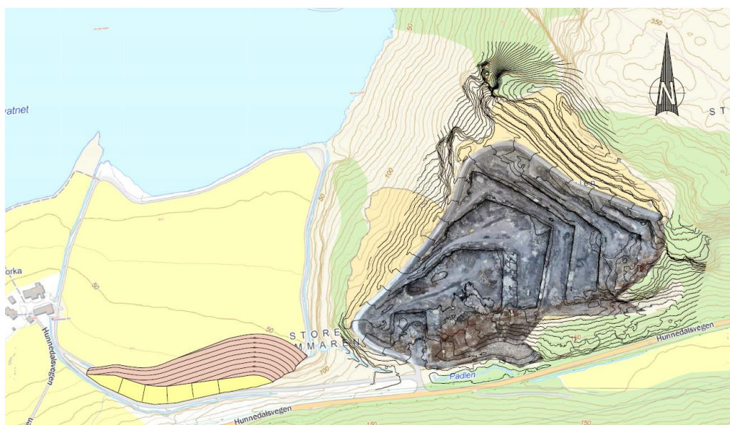
Figur 2-5 Dagens masseuttak til høyre, planlagt mellomlagring av masser til venstre. Kilde: Mibau Stema Norge
