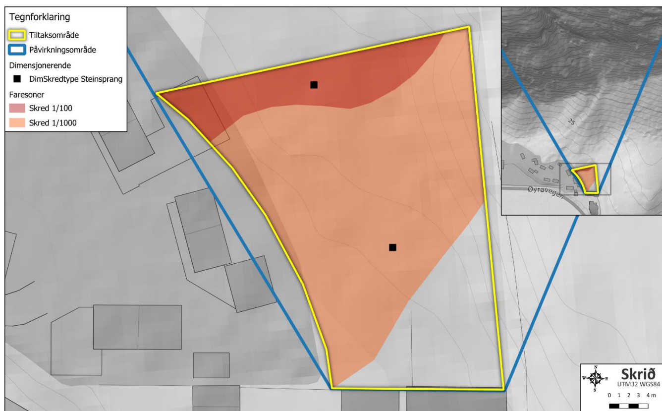
Figur 35 Faresonekart for skred innen nominell sannsynlighet 1/100 (S1) og 1/1000 (S2). Innskutt kart viser lokasjon i forhold til terreng.
