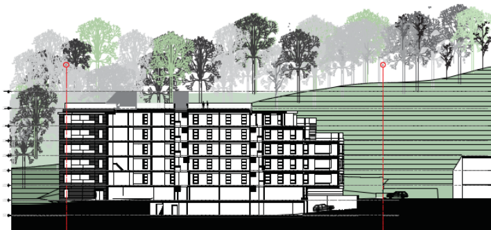
Figur 4-3 Lengde snitt (Kilde: illustrasjonshefte). I planforslaget er det sikret fire etasjer mot barnehage og at resterende del av bygget kan være 6 etasjer.
