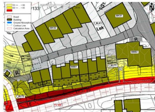
Figur 26 - Fra støyrapporten; støysituasjon før skjerming
